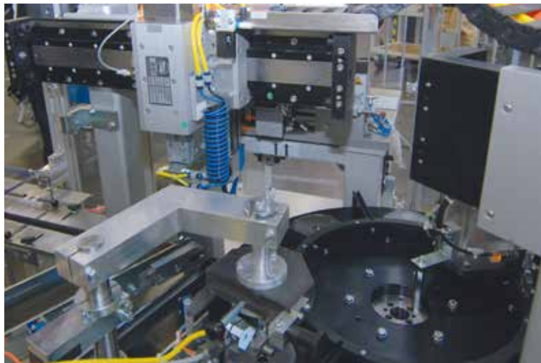
Die hohe Dynamik der WEISS Linearmotorachsen wurde voll ausgeschöpft: In einem einzigen Taktschritt werden fertige Lager nach Gut- und Schlechteilen sortiert ausgebracht und neue Lagerschalen eingelegt.
